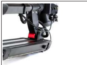
Paso 5: empujar hacia adelante y al mismo tiempo mantener presionada la palanca y bajar la barra del manillar.
