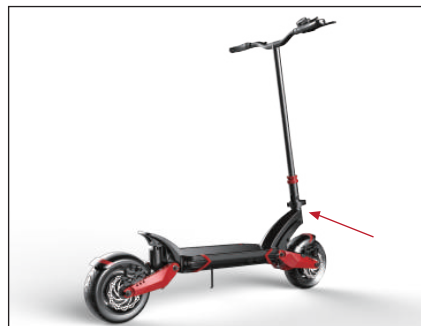
Paso 2: desbloquear la abrazadera
