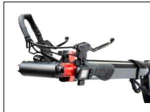
Paso 6: doblar la barra del manillar para abajo.
