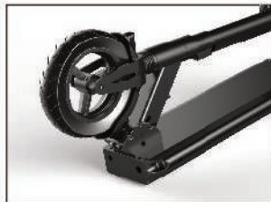
Paso 6: Empujar hacia adelante y, al mismo tiempo, mantener presionada la palanca
