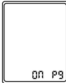
tiempo para bloquear la velocidad de cruce. Mientras tanto, si no está presionando el acelerador, la velocidad no cambiará. Sin embargo, si cambia de marcha, la velocidad de la función cambiará. Cuando termine la configuración, presione y mantenga presionado el botón M nuevamente para regresar a la pantalla de inicio.
