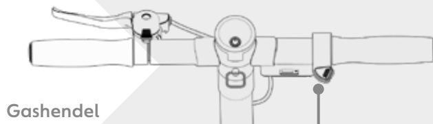
Je kan de step doen vertragen door de remhendel op de linkerkant van het stuur aan te halen. Met de enkele remhendel op het stuur bedient u zowel de elektrische rem op het achterwiel als de trommelrem op het voorwiel.
