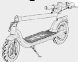
1. Sortez la trottinette électrique (en position repliée) de son carton. Relevez la trottinette en utilisant vos deux mains à partir de sa base, en évitant de la tirer au niveau de la colonne de direction.
