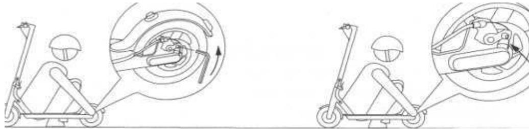
Si le frein est trop serré ou a du jeu, utilisez une clé hexagonale M5 pour ajuster en conséquence et repoussez les pistons aussi loin que possible, en faisant attention de ne pas les plier. Ne poussez pas les pistons avec un outil pointu, car cela pourrait les endommager et causer d'autres dommages.
