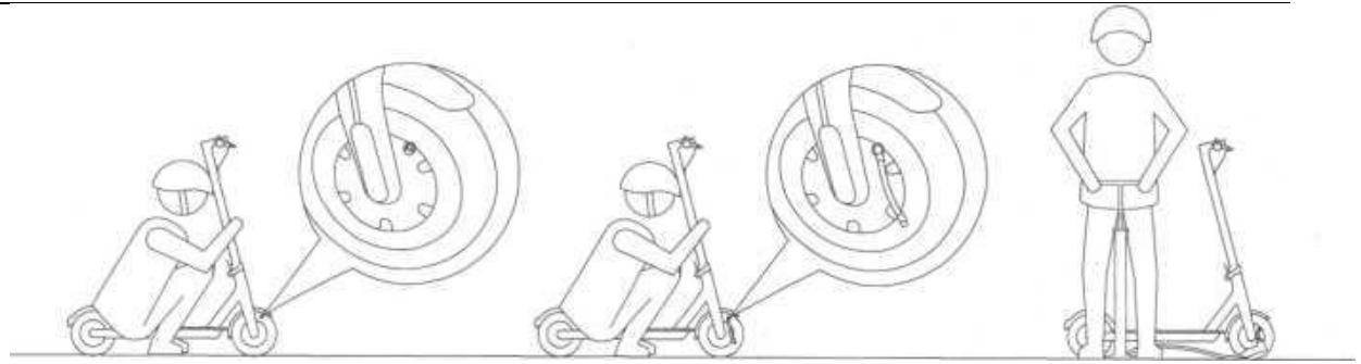
Certifique-se de que os pneus estão inflados corretamente. Estes podem ser inflados com uma bomba de bicicleta. Uma vez inflado, certifique-se de colocar as tampas das válvulas.
