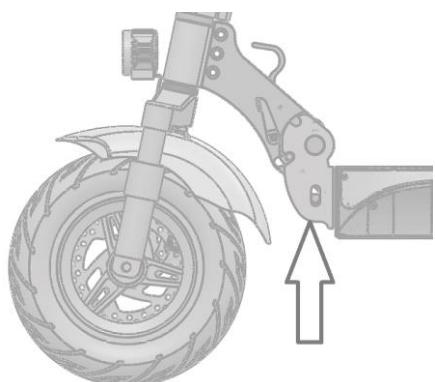
Falls Sie Vibrationen im Lenker/Vorbau spüren, verwenden Sie bitte den M5-Sechskantschlüssel, um den Klapp-/Aufklappmechanismus des Scooters einzustellen.
