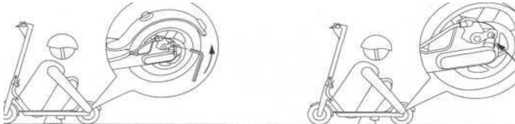
Wenn die Bremse zu fest ist oder Spiel hat, stellen Sie sie mit einem M5-Inbusschlüssel entsprechend ein und drücken Sie die Kolben so weit wie möglich zurück, ohne sie zu verbiegen. Schieben Sie die Kolben nicht mit einem scharfen Werkzeug, da dies sie beschädigen und weitere Schäden verursachen kann.
