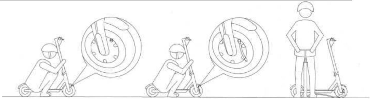
Stellen Sie sicher, dass die Reifen richtig aufgepumpt sind. Diese können mit einer Fahrradpumpe aufgepumpt werden. Achten Sie nach dem Aufblasen darauf, die Ventilkappen aufzusetzen.
