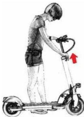
Tournez le levier de verrouillage du guidon et soulevez le guidon jusqu'à la position souhaitée. Une fois soulevé, appuyez sur le levier.
