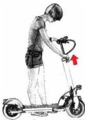
Mueva la barra de manillar hacia delante y atrás para comprobar que no se mueve y está fijada.
