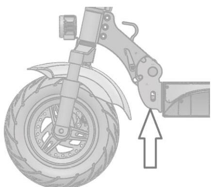
Caso sinta vibração no guiador/avanço, use a chave hexagonal para ajustar o mecanismo de dobra/desdobramento da scooter.
