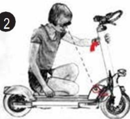
Pulse sobre la palanca de plegado y lleve el manillar hacia delante.
