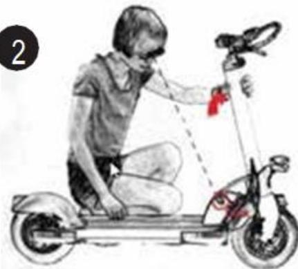
Sollevarre la leva per bloccare la maniglia di piegatura tenendo saldamente la barra di piegatura.
