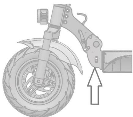
Si vous ressentez des vibrations dans le guidon/la potence, veuillez utiliser la clé hexagonale pour régler le mécanisme de pliage/dépliage du scooter.
