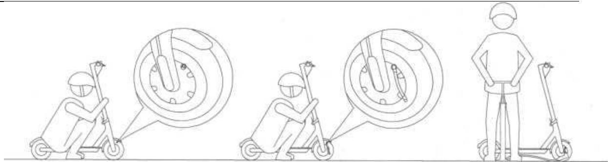
Asegúrese que las ruedas estén debidamente infladas. Estas se pueden inflar con una bomba de bicicleta. Una vez infladas las mismas asegúrese de poner las tapas de las válvulas.
