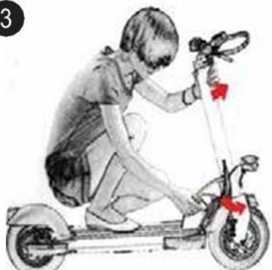
Déplacez le guidon d'avant en arrière pour vérifier qu'il ne bouge pas et qu'il est bien fixé. Vérifier l'actionnement des freins.
