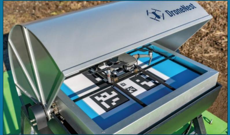
**02** 現地に設置されたポートが開き、ドローンが離陸します
