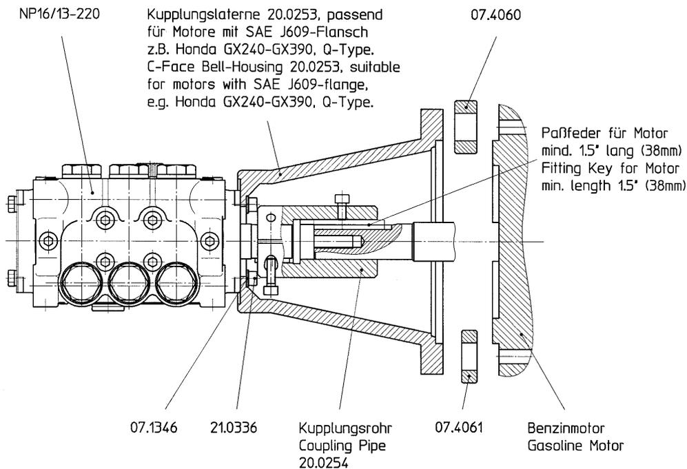
Zur Montage der Pumpe an den Verbrennungsmotor verwenden Sie bitte unseren Montage-Kit.
