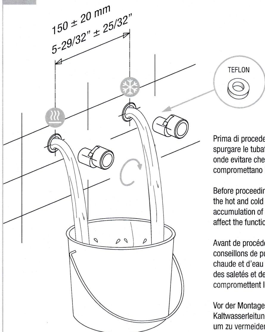
Prima di procedere al montaggio, si consiglia di spurgare le tubature dell'acqua calda e fredda onde evitare che sporcizia e piccole impurità compromettano il funzionamento del rubinetto.
