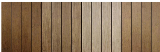
Na installatie 2 Jaar na gebruik Na schoonmaak Na Onderhoud
