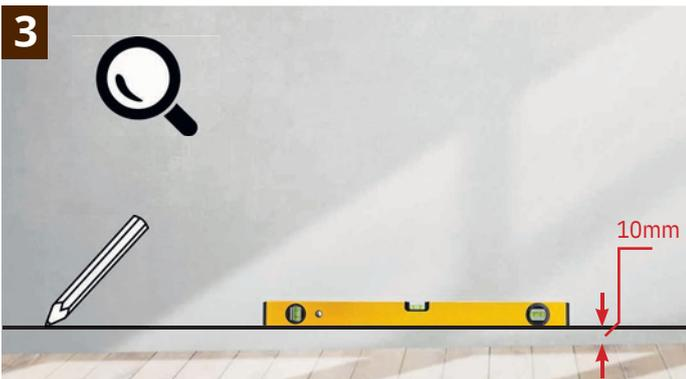
**3** Sollte der Boden ein zu starkes Gefälle haben, müssen Sie die erste Reihe der Dielen zurechtschneiden. Zeichnen Sie sich, mit Hilfe einer Wasserwaage einen Strich an Ihre Wand, um genau beurteilen zu können, wie stark das Gefälle ist. Beginnen Sie an der höchsten Stelle mit 10mm vom Boden aus.
