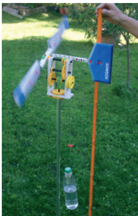
Medindo a potência da turbina
