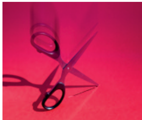
Uma tesoura é no fundo um par de alavancas. A força utilizada no corte aumenta à medida que te aproximamos do ponto de rotação ou ponto pivô.
