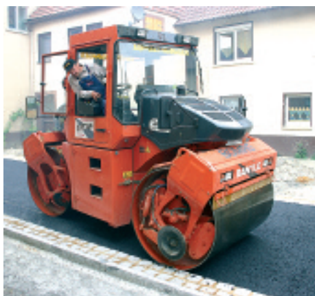
Máquina utilizada na construção de estradas que utiliza rolos para alisar o alcatrão.
