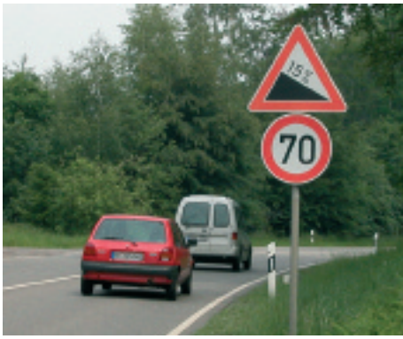
Este sinal indica que a estrada descerá 1,5 m em altura por cada 10 m percorridos.
