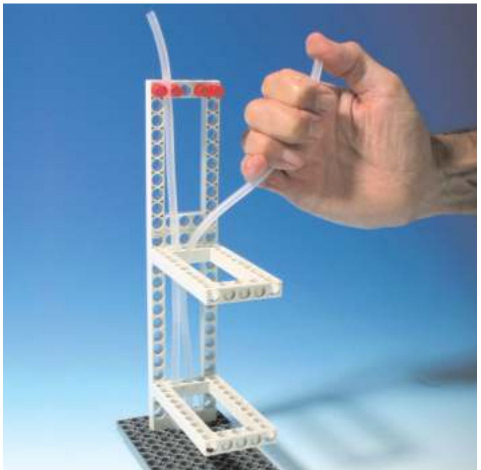
A mão a envolver a mangueira, aquece o ar resultando na sua expansão.
