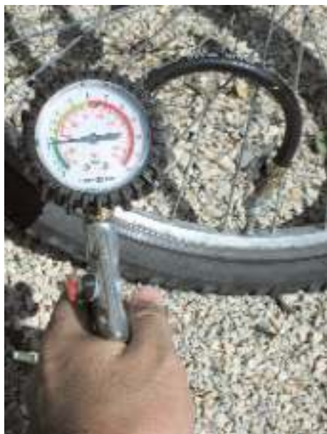
Nesta figura mostra-se como medir a pressão de um pneu de bicicleta: 2 bar = 200 kPa.
