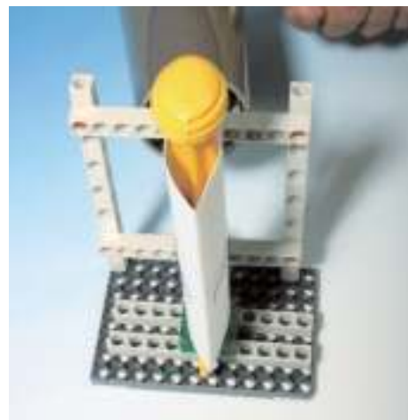
Indicador de linhas de corrente: sem nenhum obstáculo, com uma painel plano (caixa de fósforos), com um cilindro, e com uma forma de lágrima.
