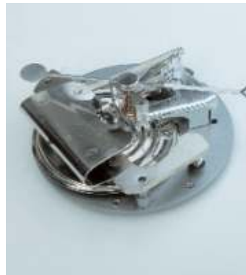
Um barómetro aneróide com o seu delicado mecanismo de transferência.
