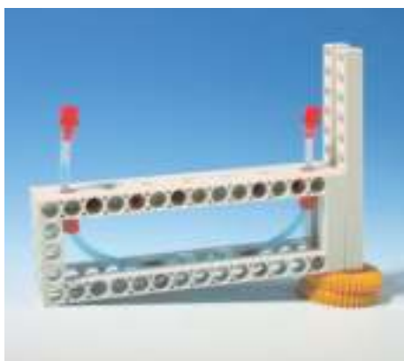
Como medir o desnível numa superfície inclinada
