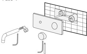
Por favor asegurese de instalar la grifería con tuberías limpias sin arena o sedimentos para evitar obstrucciones que puedan afectar el flujo de agua.
