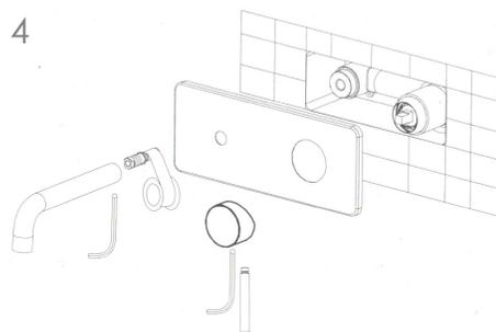
Por favor asegurese de instalar la grifería con tuberías limpias sin arena o sedimentos para evitar obstrucciones que puedan afectar el flujo de agua.
