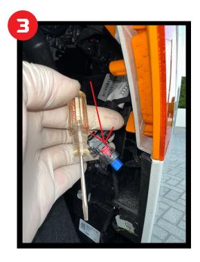
STEP THREE: RELEASE THE WIRE HARNESS FROM THE OEM FENDER LIGHT BY DEPRESSING THE RED LOCKING TAB AND PULLING THE HARNESS AWAY FROM THE LIGHT.
