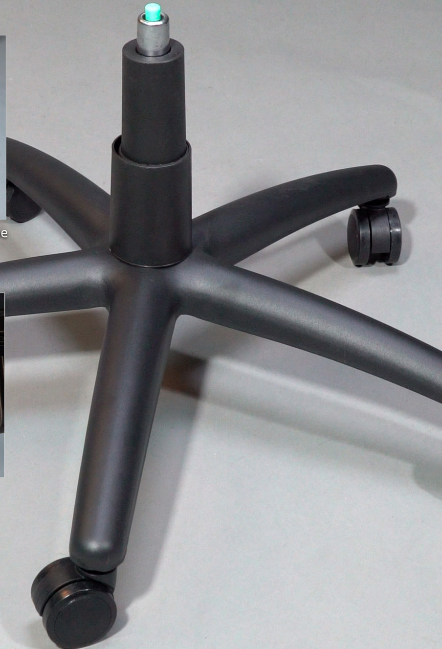
4 We fit the chair to the piston pressing lightly. Then up the cover. / Encajamos la silla al pistón presionando ligeramente. Luego lo cubrimos con el embellecedor.
