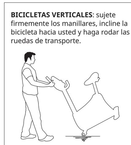
**BICICLETAS VERTICALES:** sujete firmemente los manillares, incline la bicicleta hacia usted y haga rodar las ruedas de transporte.
