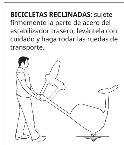
**BICICLETAS RECLINADAS:** sujete firmemente la parte de acero del estabilizador trasero, levántela con cuidado y haga rodar las ruedas de transporte.
