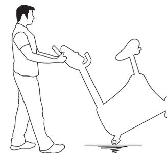
**VÉLOS COUCHÉS :** saisissez fermement la partie en acier de la barre stabilisatrice arrière, inclinez doucement le vélo et faites-le rouler sur ses roulettes de transport.
