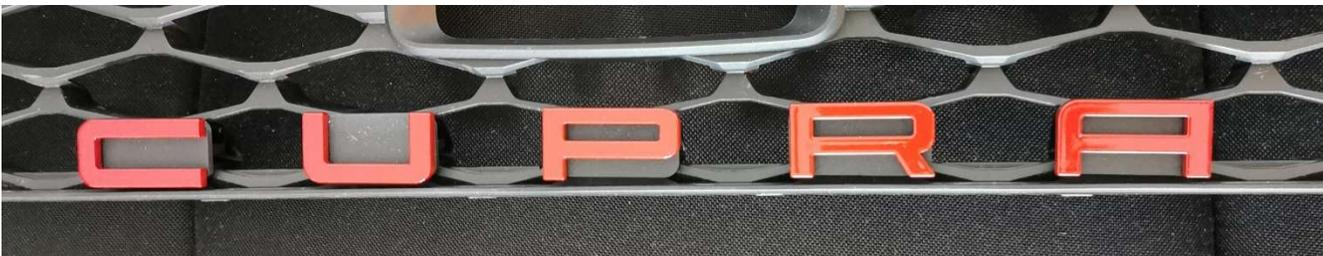
2. Bei Fahrzeugen ohne ACC kann der Schriftzug auch oben angeklickt werden, aber bei allen **IMMER** nur an der Stelle, an der sich die vertikale Wabenstrebe befindet:
