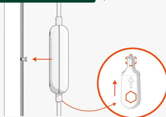
8. Visser la "vis Beembox" au mur. Faire glisser la Beembox sur la vis, à l'horizontale ou à la verticale pour la clipser.
