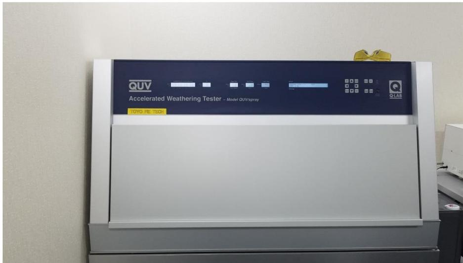
※1. UVB-313ランプを使用し通常地球上に到達しない短波長の紫外線を照射し劣化速度を最大限にします。
