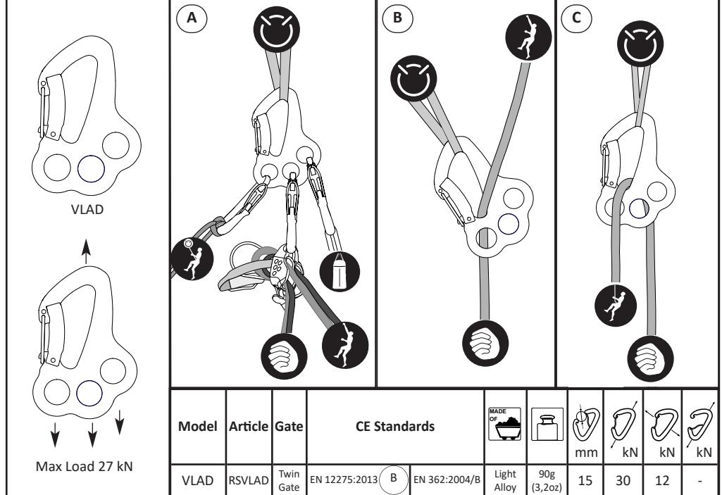
den, zum Beispiel zum Durchziehen des Seils (B) oder zum Verwalten eines Top Ropes (C) und so weiter.
