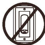
Aucun contrôle de mur à vitesse variable
