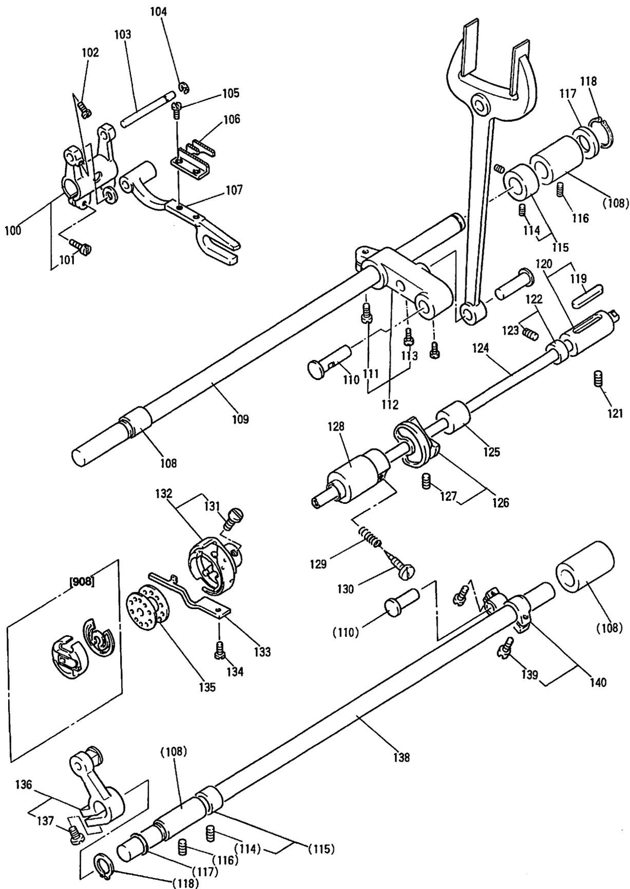
C 縫機構 (II) および下送り機構
