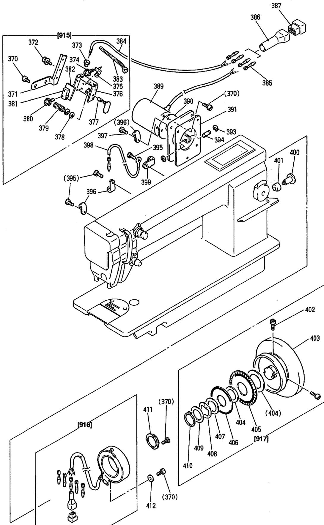
J タッチバック機構および検出器機構
