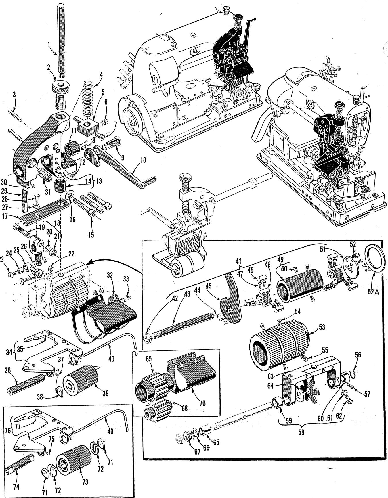
FEED ROLLER AND PULLER CLUTCH PARTS
