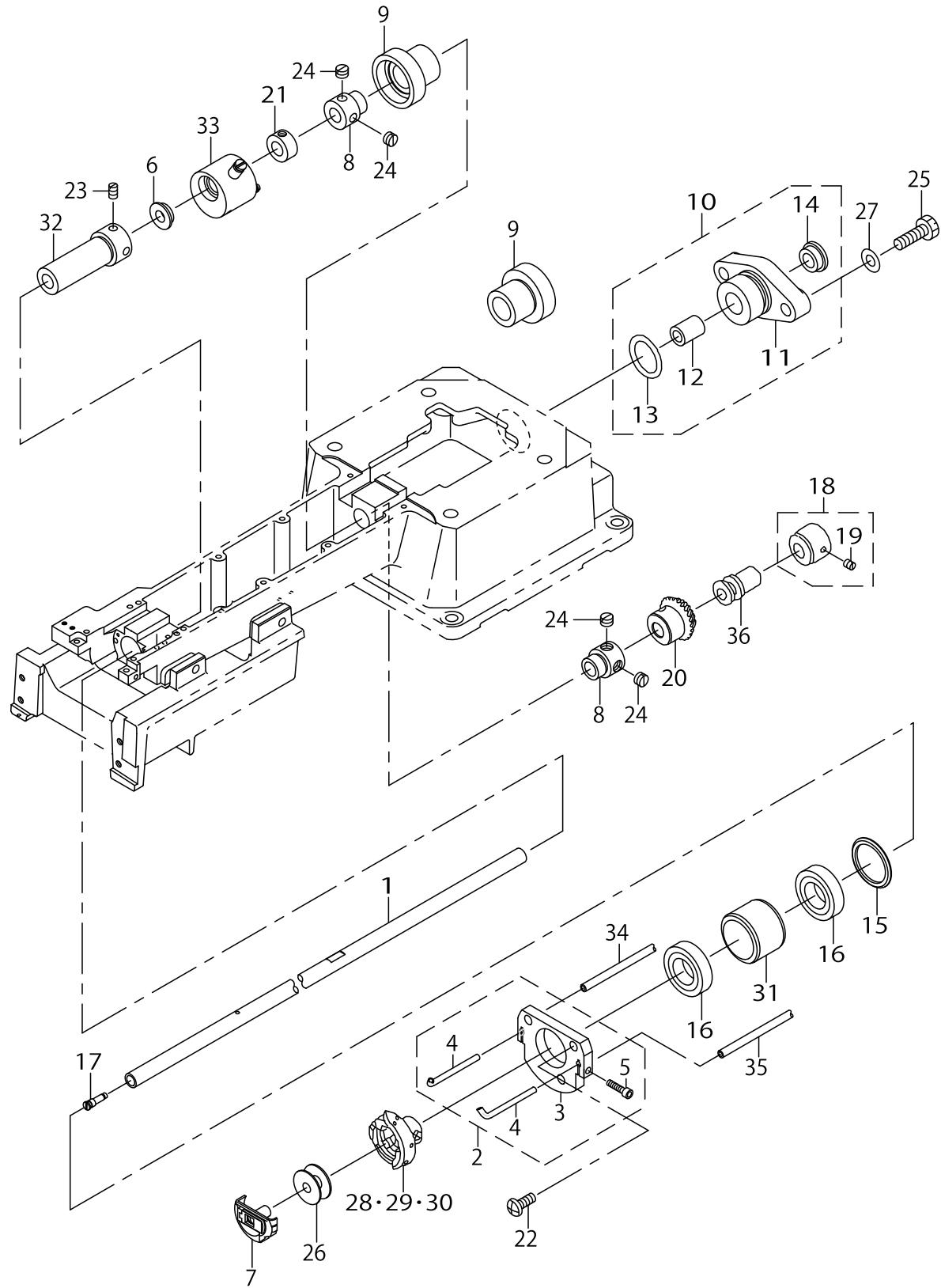
SHUTTLE DRIVER SHAFT COMPONENTS
