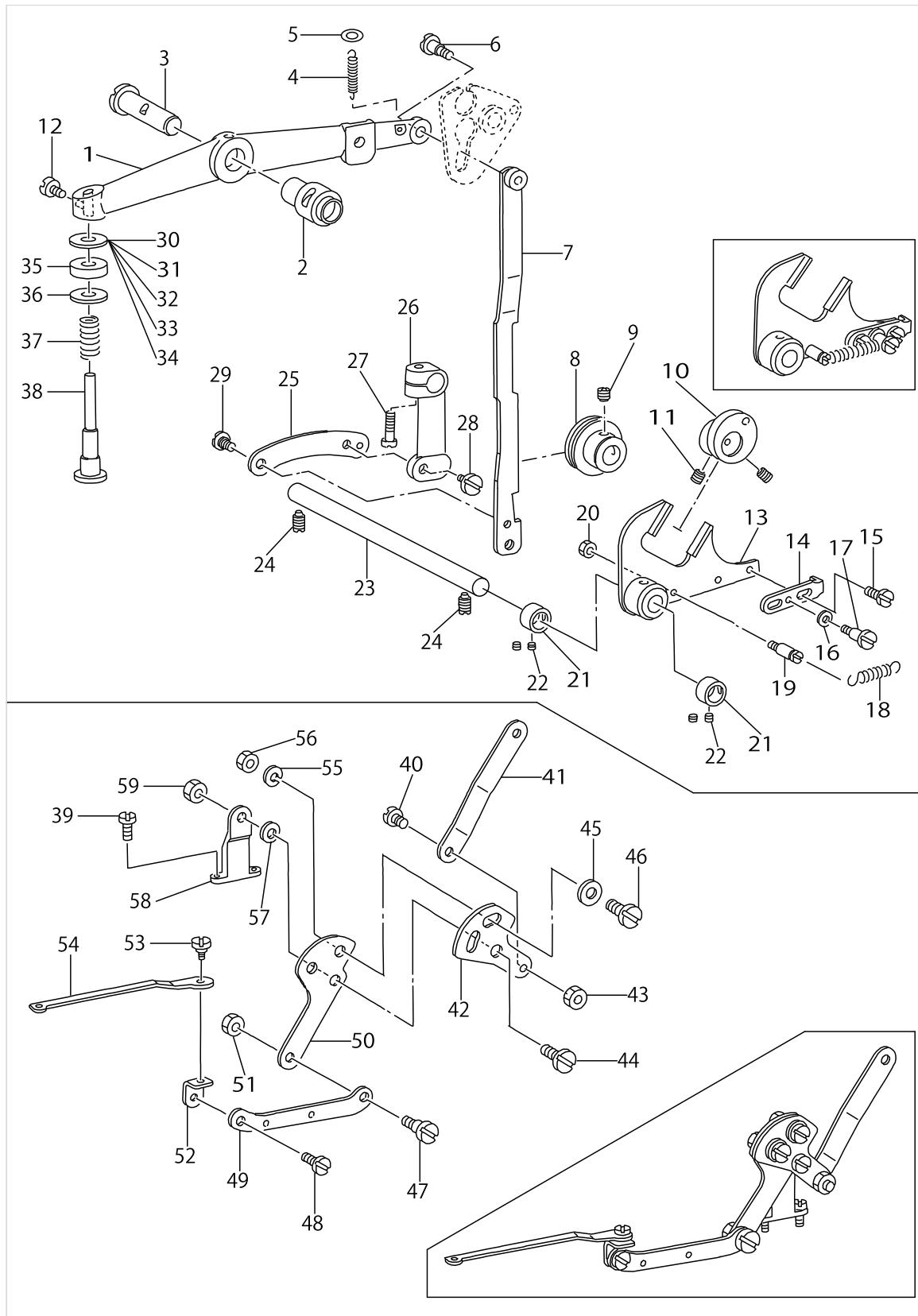
BUTTON CLAMP LIFTER & THREAD TRIMMER COMPONENTS
