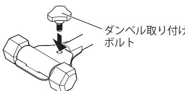
4. ダンベルの取り付け状態を確認します。
