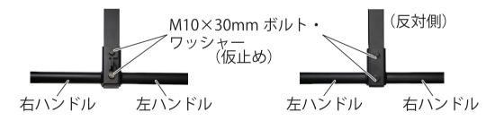
**6.** 左右のハンドルを同時にハンドルサポートに押し付けながら、仮止めしたボルトを回し、固定します。
