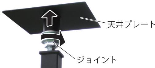
**6.** 下部パイプを抑えながら、上部パイプを手前に引き、天井プレートの上面を水平にします。
