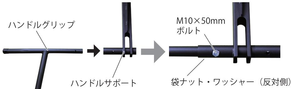
2. もう一方のハンドルグリップも同様にハンドルサポートに、M10×50mmボルト(1本)をゆっくり回しながら差し込み、M10袋ナット(1個)とワッシャー(1枚)で取り付けます。
