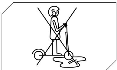
Nie jedź na hulajnodze elektrycznej po kałużach i mokrych nawierzchniach.
