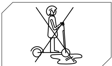
Ne conduisez pas la trottinette électrique dans des flaques d'eau et sur des surfaces humides.
