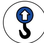
Hebestelle. Hebevorrichtungen dürfen nur an dieser Stelle und an als Hebestellen gekennzeichneten Stellen angebracht werden. Die Hebevorrichtung nicht direkt an der Hebestelle anbringen.
