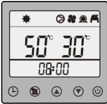
Im Klimatisierungsmodus (einschließlich Heiz- und Kühlmodus) ist die Temperatur auf der linken Seite des Drahtreglers die eingestellte Raumtemperatur (Heizen oder Kühlen) und auf der rechten Seite die tatsächliche Temperatur des Wassereinlasses.
