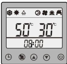
Warmwasser-Modus & Klima-Modus, das Gerät Standard-Priorität Warmwasser-Modus, so dass das Gerät läuft heißes Wasser auf den ersten, die Temperatur auf der linken Seite der Draht-Controller ist die eingestellte Temperatur der Warmwasser-Tank-Modus, und auf der rechten Seite ist die tatsächliche Temperatur des Warmwassertanks. Wenn die Temperatur des Wassertanks die eingestellte Temperatur des Wassertanks erreicht, läuft das Gerät im Klimamodus
