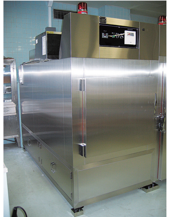
遺体保管冷凍庫 タテ型 (1体用) (3相 200V 1.5KW)
