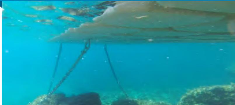
La technique d'ancrage sous-marin, utilisant des poids morts (ou ancres) avec des lignes d'ancrage, est également largement utilisée. L'ancrage d'un quai flottant utilisant cette technique imposera moins de restrictions et sera utilisé dans des eaux plus profondes (plus de 7pi/ 2m).
