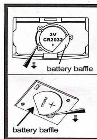
Condición 2: Abre la tapa del compartimiento de la batería en la parte trasera de la báscula, si el compartimiento de la batería es del tipo mostrado en la imagen 2.
