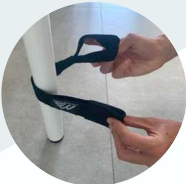
1. Wickeln Sie die Outdoor-Verankerung um die gewünschte Unterstützung (Pfosten, Stange usw.).
