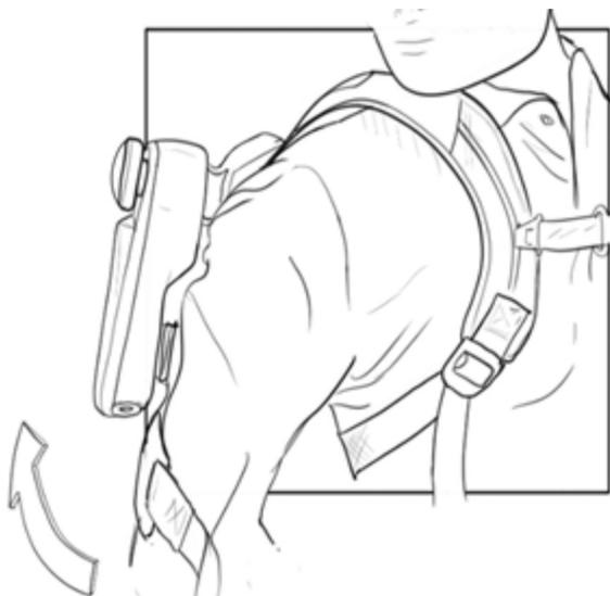
3. Bloquear el mecanismo de bloqueo de la Torque Generator Box correspondiente.
