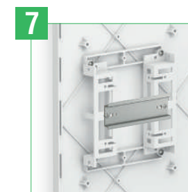
7 Flexibilidade Possibilidade de converter o espaço destinado ao DCP para instalação de aparelhagem modular , fixando a calha DIN (cód. 0029410) nos adaptadores (ver instruções página 142).
