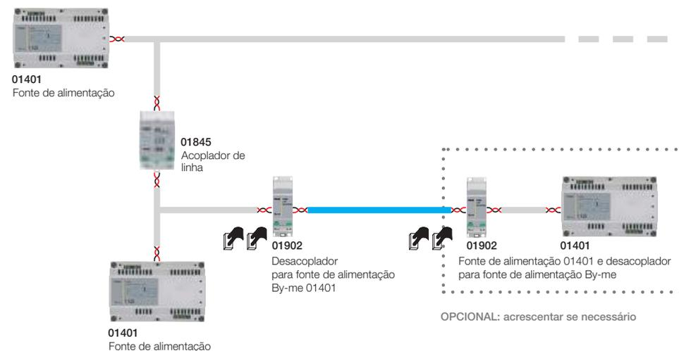
Utilização típica em sistemas onde existem muitos dispositivos de automação e é necessário adicionar dispositivos de áudio.
