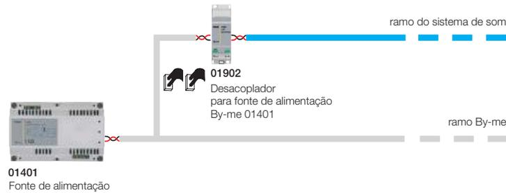
Utilização típica em sistemas onde muitos dispositivos podem ser instalados, separando o sistema de automação do sistema de som.
