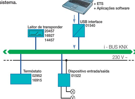
3. No final das operações o PC pode ser removido e, se necessário, reconetado apenas para funções de diagnóstico, alterações aos parâmetros, endereços e correlações funcionais ou de expansão do sistema
