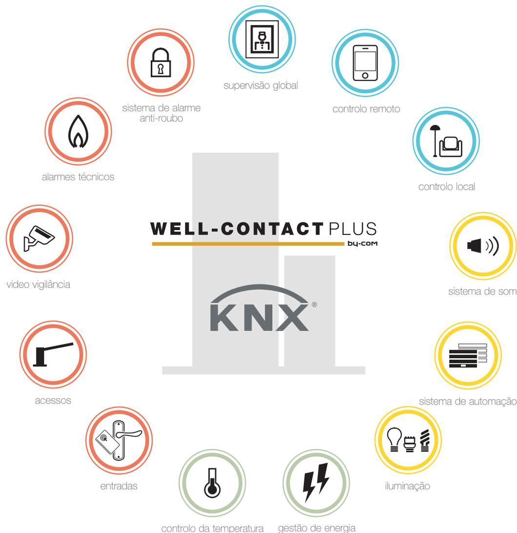
A **supervisão remota** é assegurada pelo **servidor Web** que é utilizado para gerir o sistema de Automação Well-contact Plus através de PC, smartphone, tablet ou ecrã tátil com um browser para visualização das páginas Web. O controlo remoto é assegurado através de uma rede local LAN ou Wi-Fi para:
