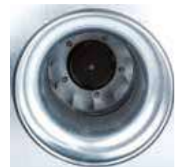
Silenciador acústico na aspiração.
