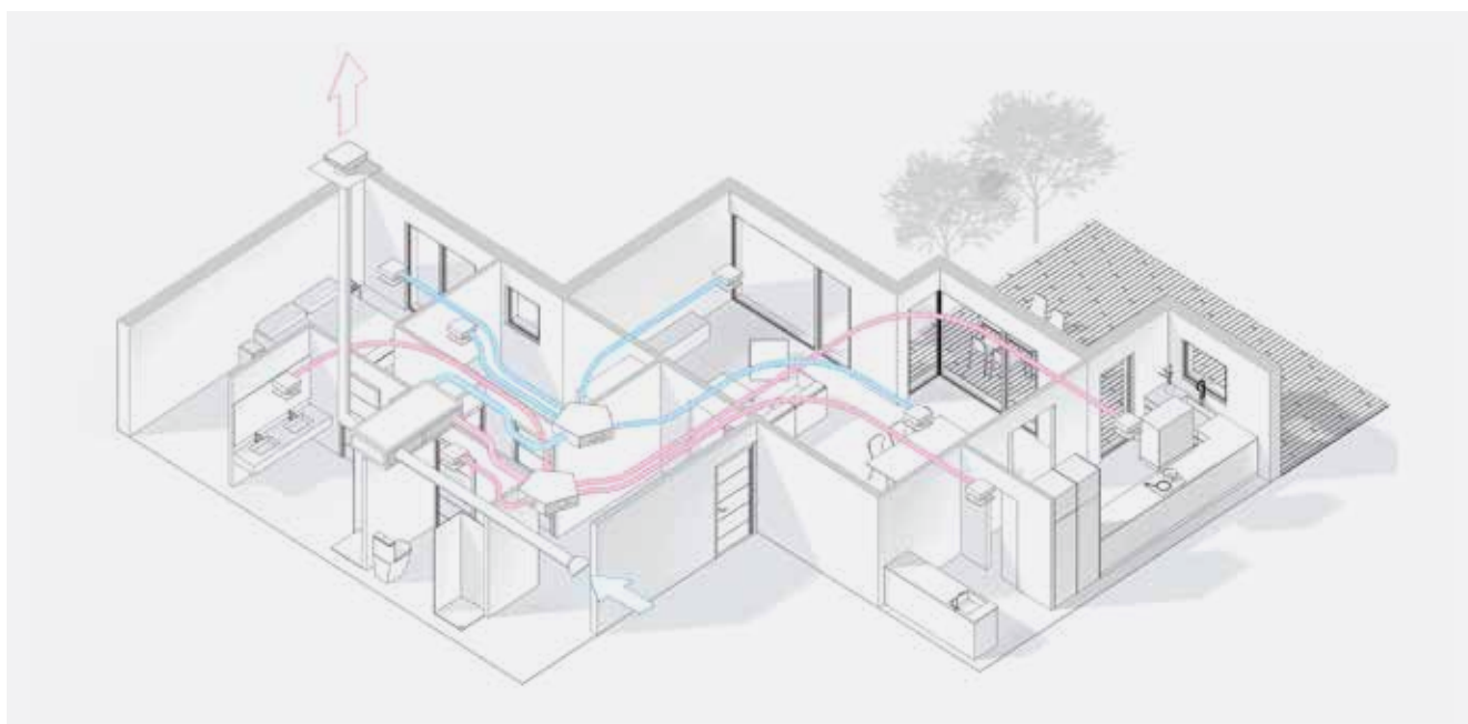
Figura 5 A distribuição é efetuada através de plenos que distribuem e captam o ar por cada divisão com redes independentes.
