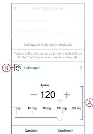
**NOTA:** Para determinar o tempo de execução padrão manualmente, registre o tempo que leva para abrir/fechar completamente o persiana (borda a borda).
