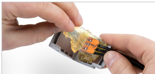
Reformulação de circuitos: Abra a caixa de gel, remova o gel do ligador, abra o ligador e conecte novos componentes ao cabo.
