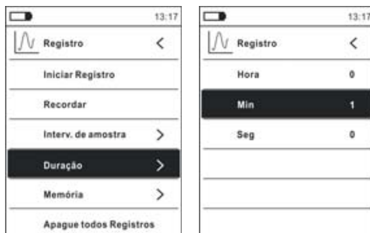
Fig. 36: Função data logger – Configuração da duração da gravação
