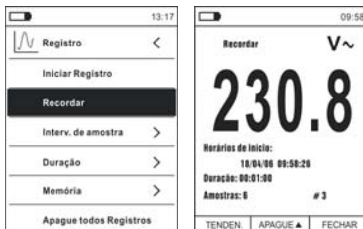
Fig. 38: Função data logger – Recordar no display os dados da gravação
