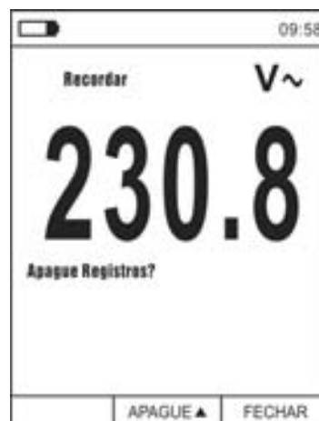
Fig. 40: Função data logger – Eliminação da gravação
