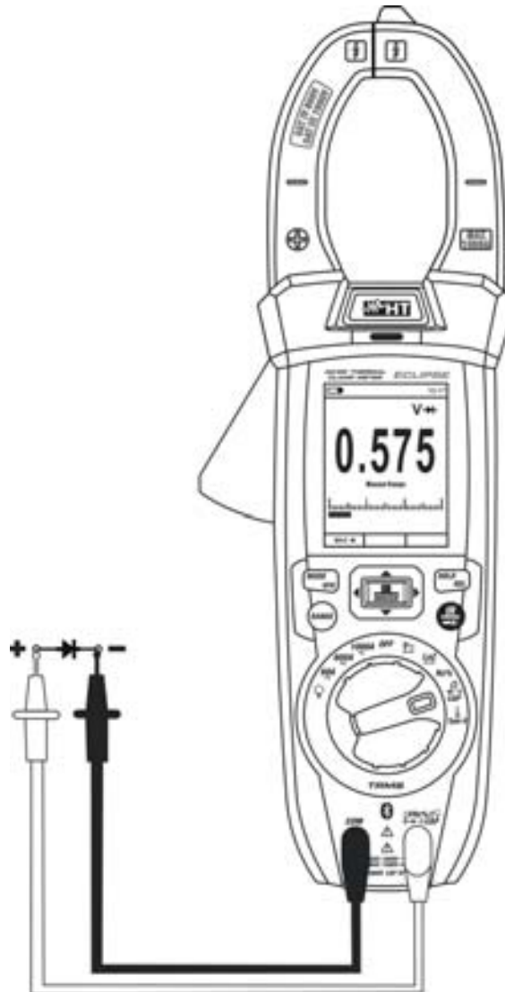
Fig. 28: Uso do instrumento para o Teste de díodos
