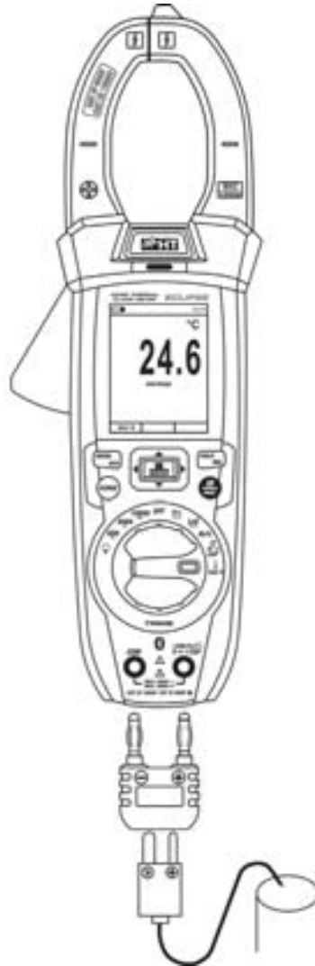
Fig. 30: Uso do instrumento para a medição de Temperaturas
