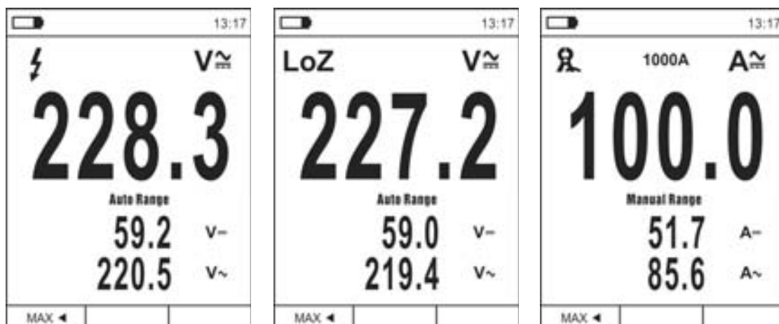
Fig. 6: Descrição da medição de tensões e correntes CA+CC
