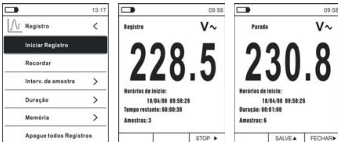
Fig. 37: Função data logger – Início e fim da gravação
