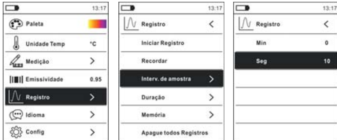
Fig. 35: Função data logger – Configuração do intervalo de amostragem
