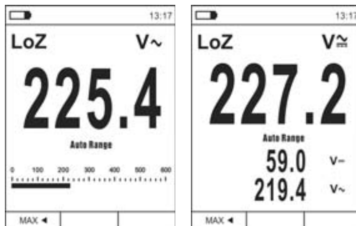
Fig. 10: Descrição da medição de tensões LoZ
