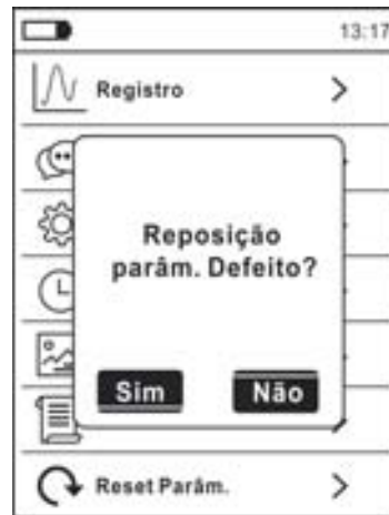
Fig. 22: Ecrã de restauro das condições por defeito
