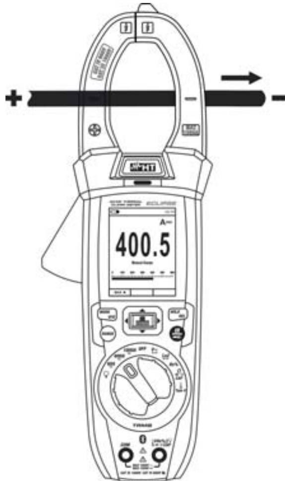
Fig. 31: Uso do instrumento para a medição de Correntes CC
