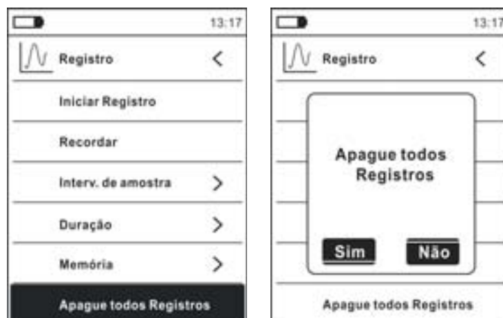
Fig. 42: Função data logger – Eliminação de todas as gravações
