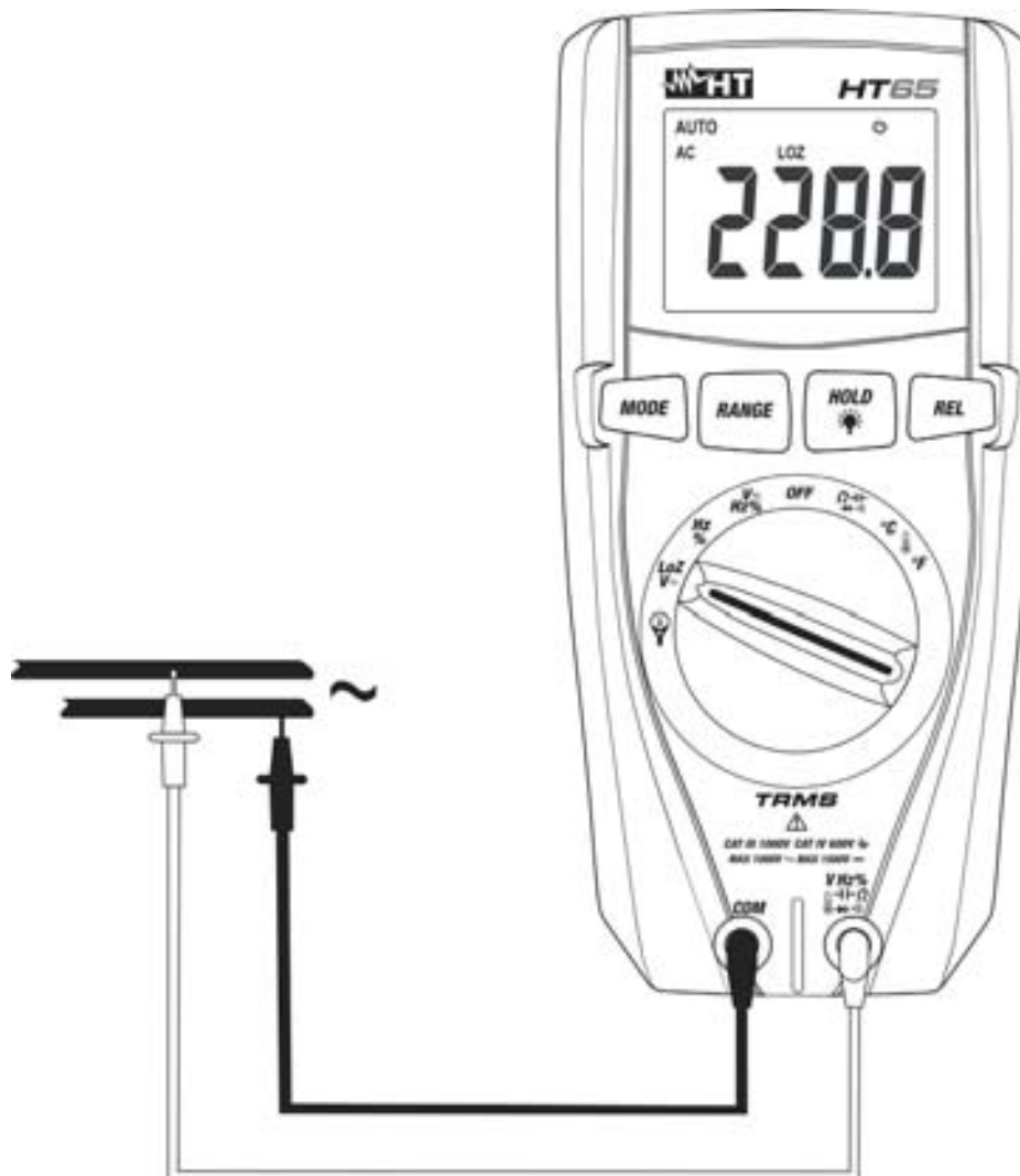
Fig. 4: Uso do instrumento para a medição de tensões CA/CC com função LoZ
