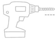
Perforaciones con taladro, Broca de muro de 5/16" a profundidad de 5.5 cm/
