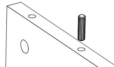
Inserta el tarugo en la perforación indicada y golpéalo suavemente hasta que llegue hasta el final de la perforación.
