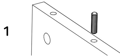
Inserta el tarugo en la perforación indicada y golpéalo suavemente hasta que llegue hasta el final de la perforación.
