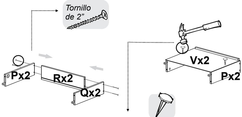
Fijar el fondo al cajón, colocando una puntilla como lo indica la figura
