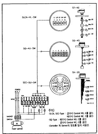
※SQ-4U-5W, SEC-5U-5W Controller에 SQ-3S, SH-4S 결 선시에는 Controller의 Com과 Low단자를 Short 시켜주십시요.
