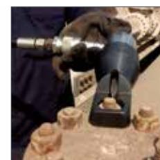
Mutternsprenger YNS/YNS-AH, SW 11-89 mm
