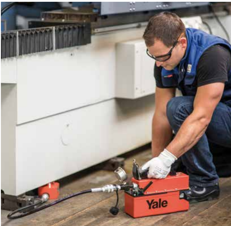
Idealer Einsatz im Zusammenhang mit kompakten, portablen Hydraulikwerkzeugen wie Spreizern, Hebekeilen, Kurzhub- und Flachzylindern sowie Mutternsprengern
