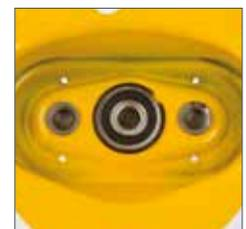
Kugellager im Getriebedeckel
