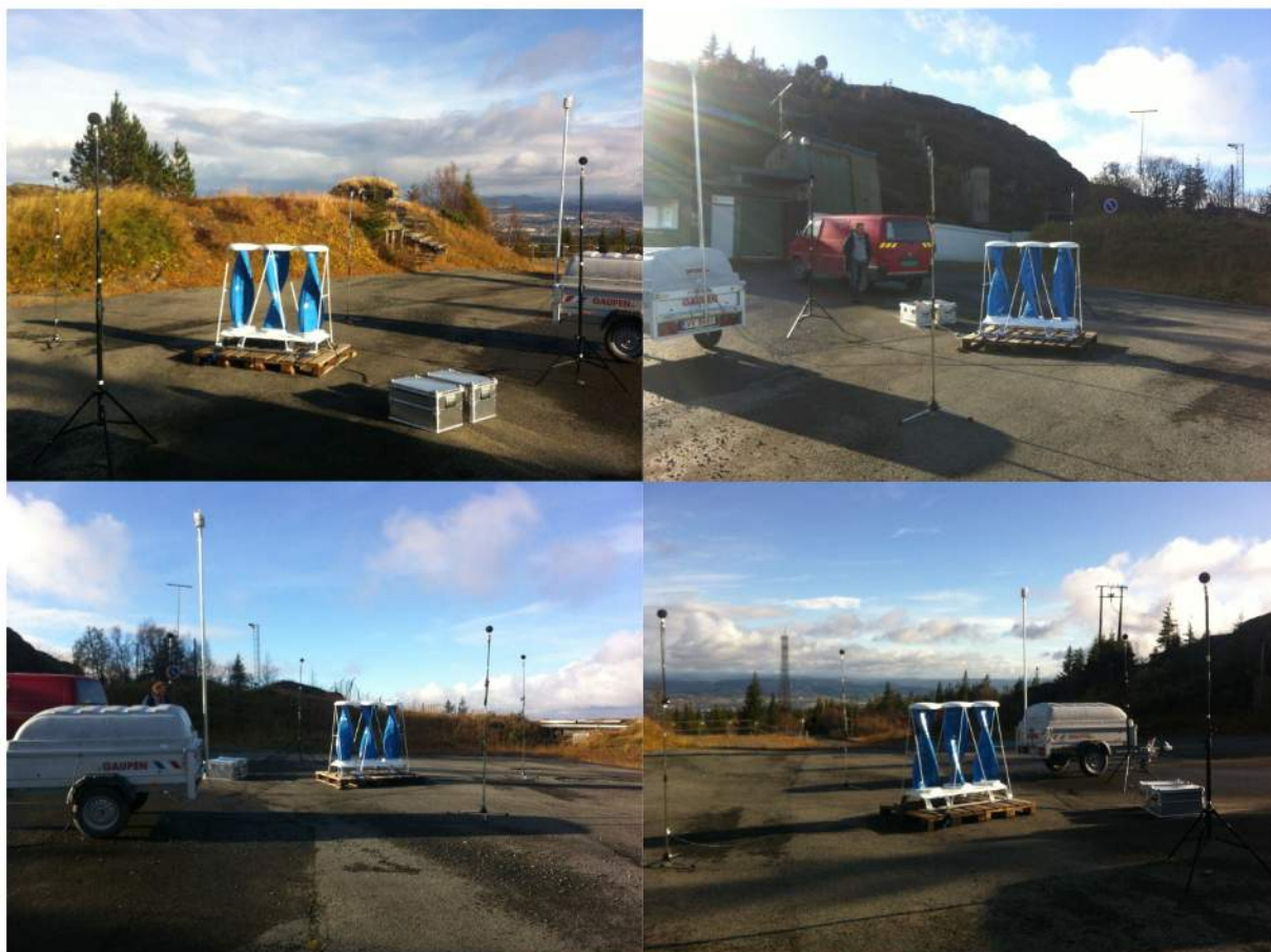
Figur 3 Bilder av måleoppsettet på Gråkallen. Tilhengeren har påmontert metrologiloggeren på en stang bak. Fire mikrofoner ble plassert rundt vindturbinen, 2,4 meter over bakken, 4 meter fra vindturbinen. To batterikasser sto plassert på bakken under målingene og fungerte som elektrisk last for vindturbinen under målingene. Tunnelåpningen kan sees foran den røde bilen på bildet øverst til høyre.
